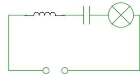
Es handelt sich um einen Siebkreis, bei dem der Kondensator und die Spule in Reihe geschaltet sind.
