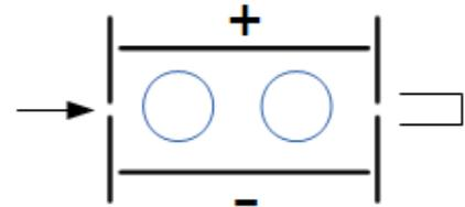
Teilchen, die den Raum auf gerader Bahn durchfliegen, treffen nach Verlassen des Raums auf ein Zählgerät. Damit wenigstens einige Teilchen gerade Bahnen haben, wird ein Magnetfeld der Stärke  $B=0,1mT$  erzeugt, dessen Feldlinien senkrecht zur Bahn der Teilchen und senkrecht zu den elektrischen Feldlinien verlaufen (angedeutet durch die beiden Kreise in der Skizze).
