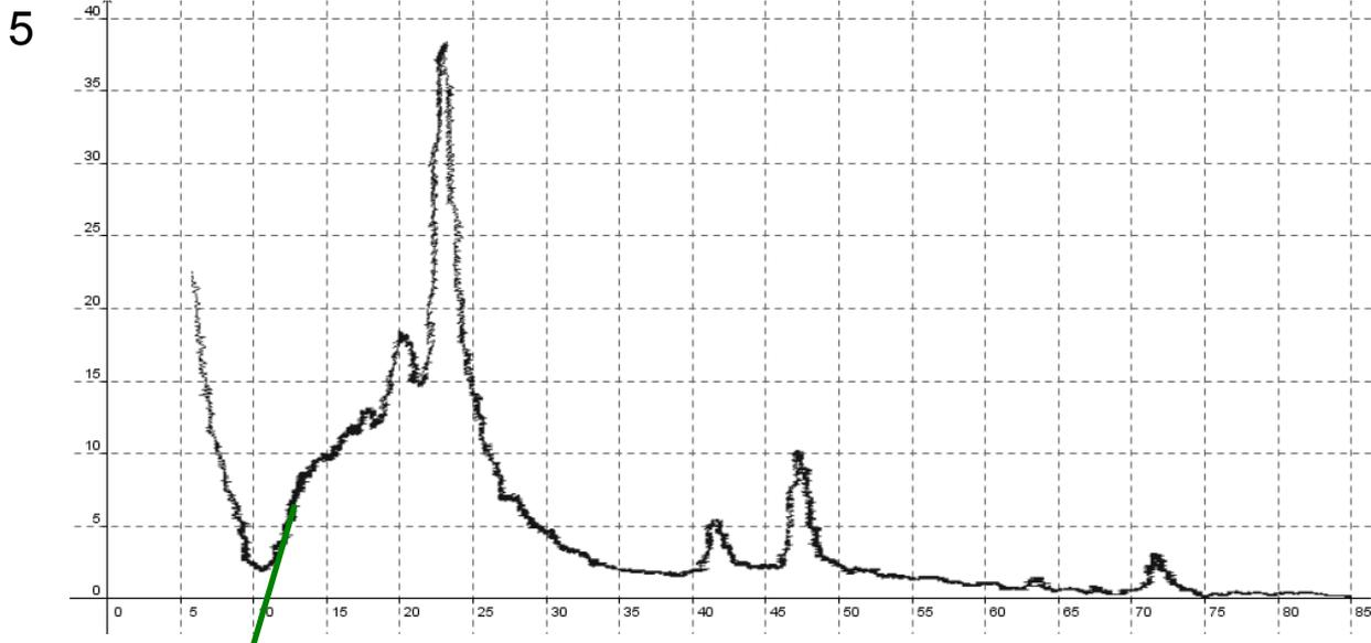
Beim abgebildeten Röntgenspektrum ist auf der waagrechten Achse der Beobachtungswinkel in Grad ( $^\circ$ ) abgetragen, auf der senkrechten Achse die Intensität der Röntgenstrahlung.
