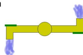
*Das Wasser wird in das Rohrsystem gepresst und übt innen überall die gleiche Kraft auf die Innenwände aus. Bei gegenüberliegenden Innenwänden heben sich diese Kräfte gegenseitig auf.*
